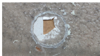
Prova di Trazione a rottura su ceramica. Valore medio 2,5 N/mm 2
