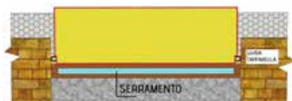
Lithopor mod. 3: Davanzale dritto con alloggi per guide tapparelle
